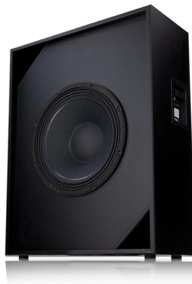
SB-1180为小影厅系统提供了高品质的声音,拓展了QSC的电影市场。作为DCS数字电影扬声器系列的一员,SB-1180次低频扬声器提供了一个独特的解决方案,满足了数字影院在小影厅应用低频扩展的要求。SB-1180采用单18" (457mm) 低音与4" (102mm) 音圈实现低频还原。SB-1180是外形最小巧的次低频扬声器之一,拥有不超过12" (300mm) 深度的紧凑型箱体,大大降低了对银幕后安装的空间要求。
